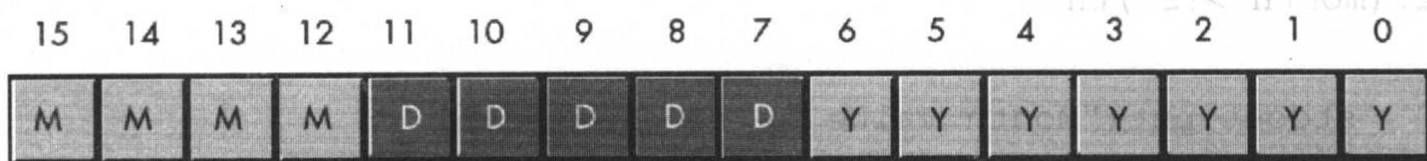
图 2-20 短的压缩数据格式(两个字节)
