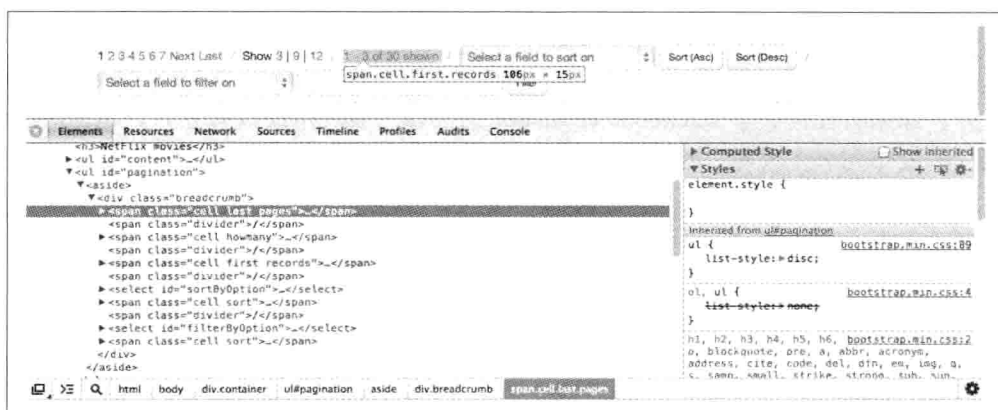
图 10-5 使用 Chrome DevTool 控制台提供的 CSS 样式属性查看功能检查分页内容
