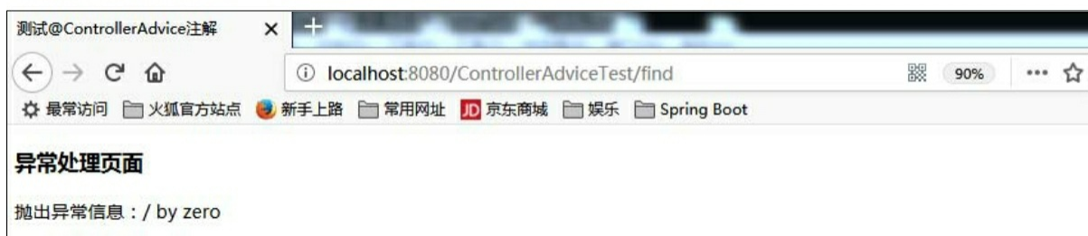
图3.34@ControllerAdvice异常处理页面
