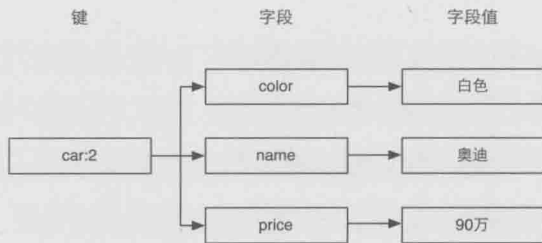
图 3-5 使用散列类型存储汽车对象的结构图
