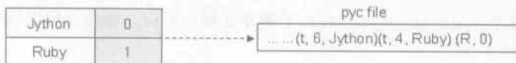
图 7-6 采用了 TYPE_STRINGREF 后的 pyc 文件
