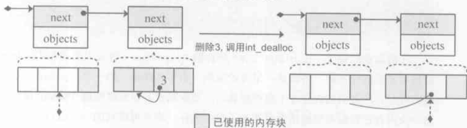
图 2-8 不同 PyIntBlock 中的空闲内存的互连
