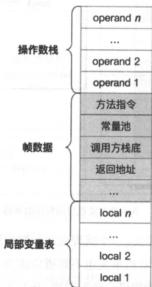
图 3-3 Kotlin 栈帧结构
