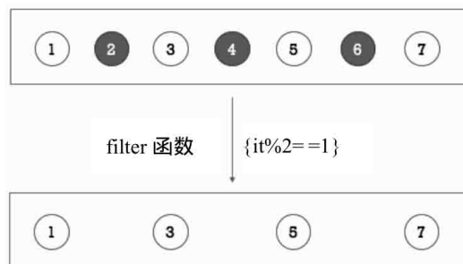
图5-1 filter函数的映射过程
