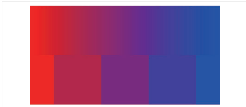
图 4-2：使用渐变和不透明度混合颜色的对比；正方形由蓝色正方形和位于其下部的纯红色长方形组成，蓝色正方形的 fill-opacity 值分别为 0、0.25、0.5、0.75、1
