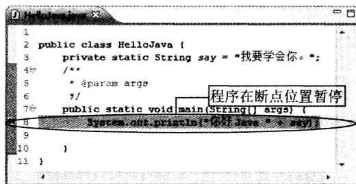
图 2.26 程序执行到断点后暂停
