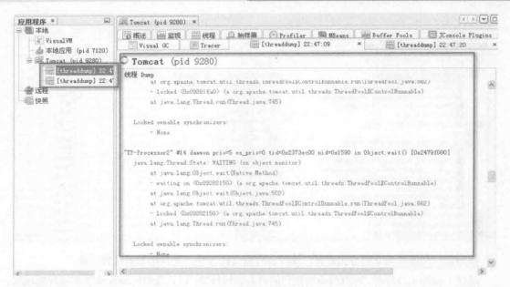
第二种方式是,在 Java Visualvm 工具里面安装 JTA 插件,分析线程 dump 文件。注意,正常阶段的 dump 文件与非正常时期的 Dump 文件进行比较更容易分析出问题。下载地址如下:
