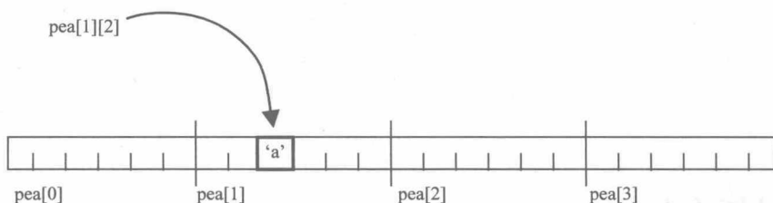
图 10-2 实际上的二维数组内存布局
